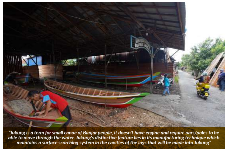
"Jukung merupakan sebutan untuk sampan kecil bagi masyarakat Banjar, tak bermesin dan memerlukan dayung/galah agar bisa melaju di air. Ciri khas Jukung terletak pada teknik pembuatannya yang mempertahankan sistem pembakaran pada rongga batang kayu bulat yang akan dibuat menjadi Jukung"
